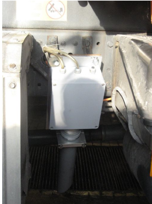
Figur 4: Installation av vattenfilmsmätare från Infralytic GmbH på saltbil.
